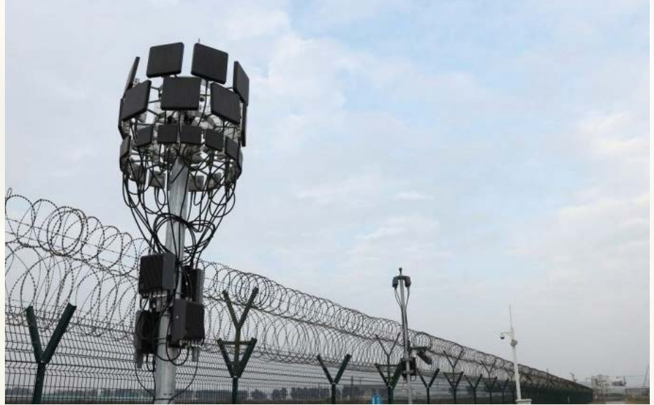
Drohrendetektion bei einem Gefängnis
